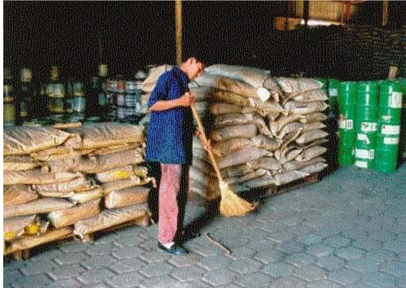
*Foto No. 7. Intentos de ordenamiento y aseo en las bodegas estatales de Chinandega, Nicaragua. Nótese la falta de equipo especial de protección personal y el piso permeable. (Cari Reece, Octubre de 1999)*
