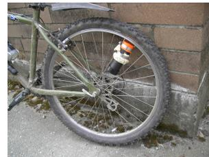
Una centrifuga puede ser hecha utilizando tubos de PVC en una rueda de bicicleta. La amalgama resultante tiene menos mercurio y más oro
